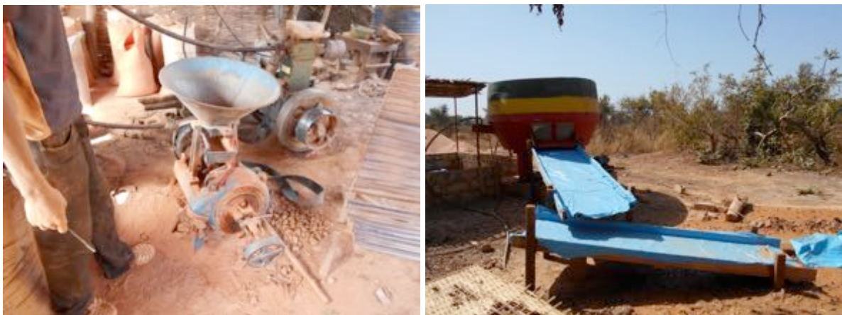
Photo 2 : Machine broyeuse de pierres (Tombrankoto) et dispositif mécanique de lavage (Bantako) Source : Mbaye, Badiane et Ndiaye, 2015
